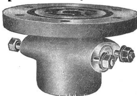
Fig. 4. Präfluftentöler mit abgenommenem Deckel für 90 Atm. Druck aus Elektrostahl.
